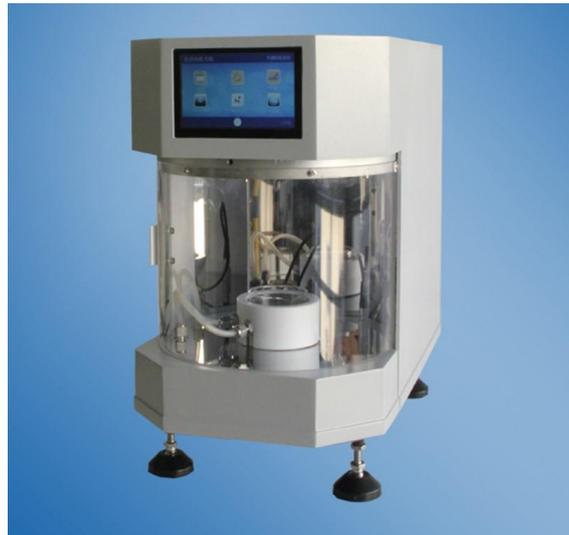
JK99M 全自动张力仪符合 SY/T5370-1999 表面张力及界面张力测定方法行业标准。界面张力：液体与另一种不相混溶的液体接触，其界面产生的力叫液相与液相间的界面张力，通常把液相—气相之间的张力称为表面张力，例 20℃ 时水的表面张力是 72.75，就是指水与空气界面上的表面张力。我们又把液相—液相之间的张力称为界面张力。测量方法主要铂金板法、铂金环法，应用领域：三次采油（化学驱）的室内研究及现场监测；表面活性剂、洗涤剂、乳状液和泡沫研究；燃料油、润滑剂、油漆、油墨及涂料研究；农药等方面研究等。全自动张力仪还可根据客户的不同要求可以选配磁力搅拌、cmc 浓度测量、密度测量、粉体测量、纤维接触角测量、动态接触角测量等功能，也可以配置成一体两用机内置液晶数显和小型打印机，可以单机独立操作，也可连接电脑控制观察张力曲线动态变化。
