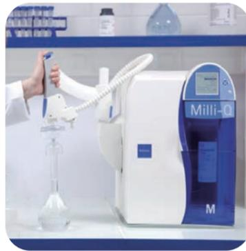
低流速功能可对容量瓶中的弯液面进行精确调节。
