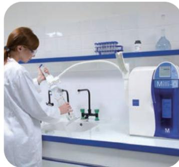
长达 75 cm 的水管可伸入清洗槽，方便清洗玻璃器皿。
