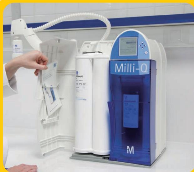
位于 Milli-Q™ Reference 纯水系统左侧门内的快速参考指南，可提供快速的信息检索。系统附带光盘，提供 8 种语言的完整、详细的用户手册。印刷手册中包含基本的设备及操作信息（中文）。
