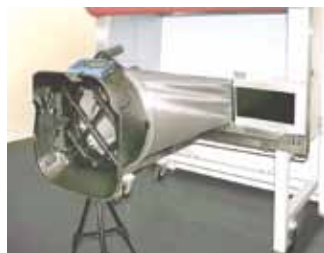
8380 直接测试生物安全柜的进风流量 ( 当使用生物安全柜套件 BSC Hood Kits)
