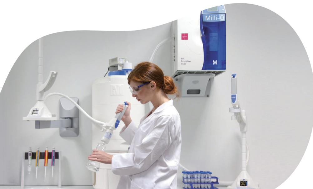
对于需要 II 级 (纯) 水以满足实验室基础应用, 同时又需要 I 级 (超纯) 水以实现专业应用的科学家, **Milli-Q® Integral 一体化系统** 提供了完美的解决方案。采用全面、最佳的水纯化程序和监测技术, 使用一台独立系统即可从普通自来水直接生产纯水和超纯水。Milli-Q® Integral 系统用户不仅得到了便利, 也在节约了运行成本的同时节省实验室空间。
