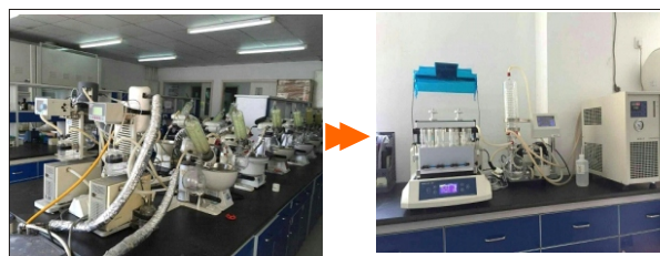
批量处理样品，与使用多台旋转蒸发仪相比极大节省了实验室空间
