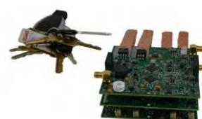
当通过ICE-CS1 and ICE-CP1驱动两个激光器时，用户可在250 MHz - 9.3 GHz之间调整得到主从激光器之间真正的相位锁定。
