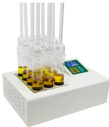
此款仪器是 COD 经典方法分析中环保节能的新型加热装置, 依据国标方法 (GB11914-89) 设计 (新国标 HJ\_828-2017 也可使用) 采用空气冷凝代替水冷凝, 采用新型温控器, 石墨加热炉, 耐腐蚀, 大屏幕液晶显示、自动控制加热温度、加热时间。耗电小、节能、节水、操作简单、性能稳定可靠, 独特的防爆沸设计, 保证实验安全。
