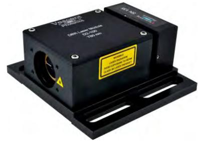
D2-100-DBR激光器紧凑灵活可靠，整个激光器模块被安装在4×4 inch的底座上。在具有温控与光束整形功能（变形棱镜对）的模块封装内，包含一个分布式布拉格反射（DBR）激光二极管与一个35 dB的光隔离器。该模块封装对震动非常不敏感，由于腔短（~1 mm），通过电流调节可实现超过40 GHz的无跳模调谐。因此，该激光器可与D2-125伺服器或者其他环路滤波器形成迅速的尽心伺服控制，达到对原子分子之间转换的轻松锁定。而且，由于模块内无任何活动件和压电器件，因此结构非常坚实稳固。采用0.55 NA透镜对激光二极管光束输出进行准直，此透镜安装在能够进行指向性调整的移动平台上。DBR激光器的温度和电流调谐系数为外腔半导体激光器（ECDLs）的2-3倍。我们采用两级温度控制，并通过具有快速伺服输入的D2-105精密低噪音电流控制器进行驱动，达到对激光器灵敏性能的精密控制。因此，D2-100对环境改变的反应比传统ECDL快很多。
