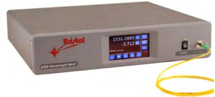
828系列波长计采用独特费佐标准具设计，得到 $\pm 1 \text{ pm}$ 的波长测量精度与1 kHz的测量速率，设计用于WDM测试应用的快速波长量。通过降低测试时间，实现WDM部件生产的效率提升。更重要的是，1 ms的时间分辨率可以实现对可调谐激光器的详尽分析。
