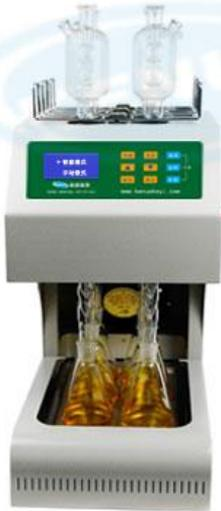
1. KN-COD12是集加热,消解,回流,冷却于一体的回流装置
