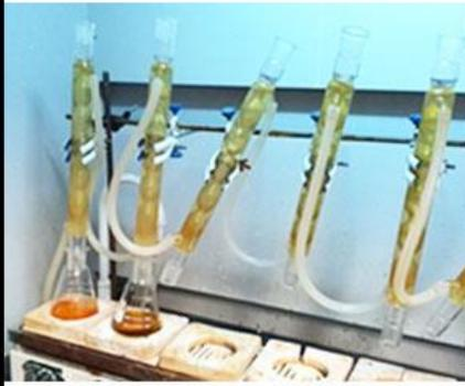
1. 此传统装置为电炉加热与水冷凝相结合的加热回流装置
