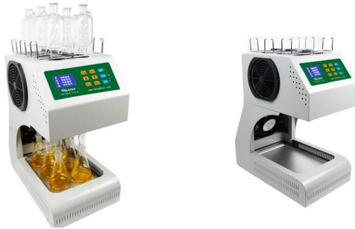
此款仪器采用高温 COD 回流消解方式，保证水样反应完全。消解过程中采用风冷却回流模式代替水冷却回流模式，节约水资源。冷却时，增加风冷却系统，大大节约检测时间。依据国标方法（GB11914-89）设计（新国标 HJ\_828-2017 也可使用），在手动操作模式之外添加智能模式，一键操作，完成消解、冷却过程。配备专用冷凝管支架，操作更安全。
