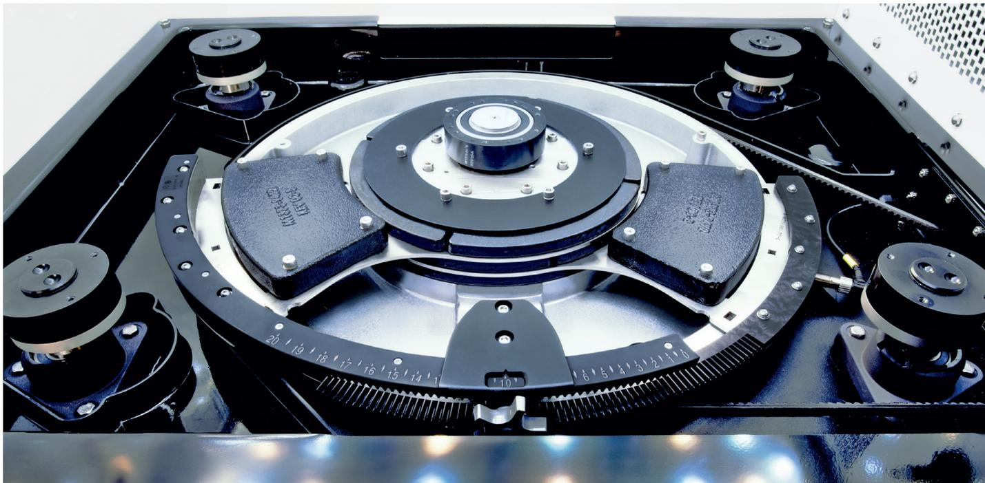
新型 Eppendorf X-Drive 驱动装置让摇床运行更快、更稳、更持久。五个承载摇床板的偏心轴精确设计，确保年复一年稳定的运行表现。
