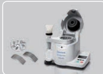
旋风磨**TWISTER**专用于针对红外检测的样品制备。旋风分离器保证样品处理过程中不升温、不变性。
