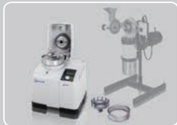
RETSCH的超离心研磨仪**ZM200**适用于粉碎软性的、中硬性的及脆性样品，进样尺寸约10mm，出样粒度达40um。旋转敲击式研磨仪SR200和SR300用于大样品量的粉碎。
