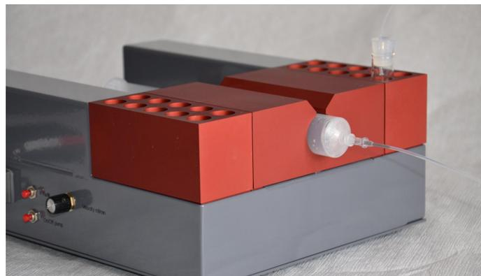
多功能卵泡冲洗器™ 把注射泵和恒温装置结合起来，可大大节约了拥挤的取卵室空间，同时可不再用专人手动操作注射器。
