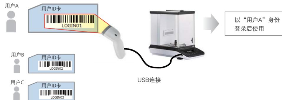
使用AP系列的登录功能时，需按用户分别输入密码。使用条形码识别器，读取各用户管理的条形码，则无需输入密码即可进行登录。
