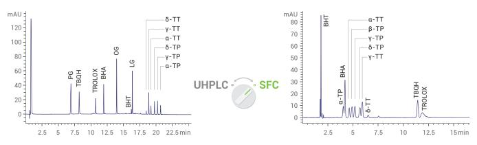
使用 UHPLC(左图)和 SFC(右图)分离和紫外检测植物油中的 14 种抗氧化剂。各抗氧化剂的浓度均为 10 µg/mL
