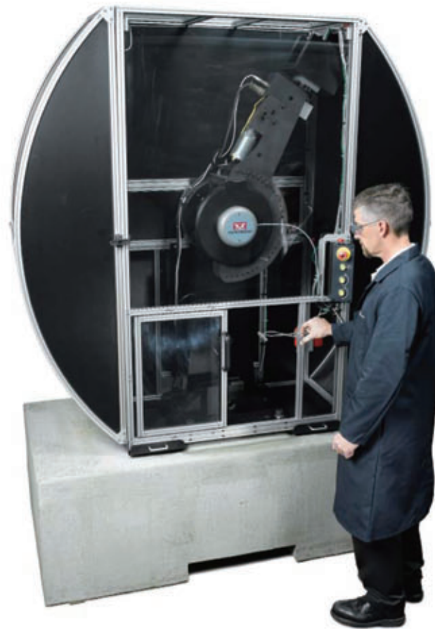
450MPX冲击试验系统 注: 英斯特朗不提供地基, 具体要求参见安装手册。
