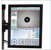
NEXUS 3001XLM-IMP还可以仅仅作为 布氏压痕机来使用,即屏蔽 IMPRESSIONS™软件功能。 NEXUS 3001XLM-IMP标准配置有自动电动丝杆,可以进行全自动测试。
