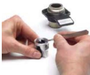
X- 断面观测插件制样过程
