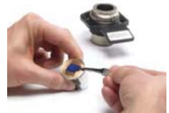
微型电子器件插件制样过程
