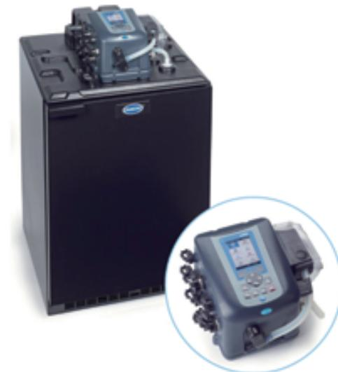
冷藏式采样器在现场固定使用，能在潮湿和腐蚀的环境下正常工作。制冷机为不锈钢材料。通过空气感应温度调节控制冷藏温度，高效压缩机、冷凝器、蒸发器和严密的泡沫塑料隔离装置保证最佳的4°C水样温度。强制空气吹扫和前部通风使得采样器可以灵活地安放在墙旁边，或者是采样器外罩中。键盘、开关、显示屏都具有防水、防腐蚀功能，密封的连接件和泵轴保证了采样器不受所处环境的影响。
