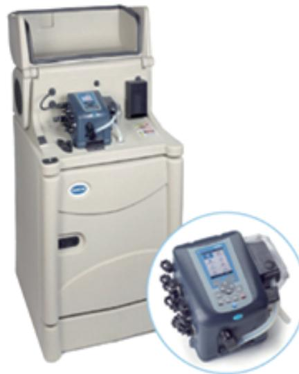
全天候冷藏采样器，能够保证水样的保存温度在4°C。压缩机放在了采样器的顶端，可避免硫化氢和其他比空气重的腐蚀性气体对其造成的损害。采样器配备的高强度、抗化学腐蚀的外罩，能更好地保护制冷管线不受潮湿和腐蚀气体的侵害。系统的感应器通过对蒸发器的温度、环境空气的温度、样品液体的温度的连续监测，由微处理器控制水样室的升温。全天候冷藏式水质采样器提供的是对环境无害的、不含氟里昂的制冷剂。
