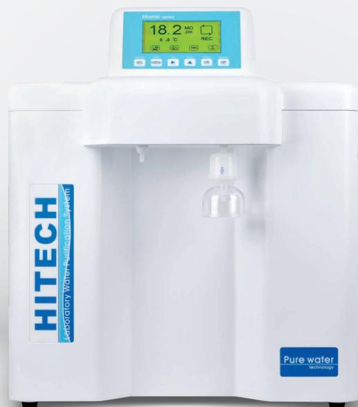
高级别实验室用超纯水的必备**优越选择**，以自来水为水源，方便快速的制造超纯水，每小时产水量 15-30 升，电阻率达到 18.2MΩ·cm，完全符合 GB6682-2008、ASTM、CAP、CLSI、EP 和 USP 制定的 I 级水质的最高标准。
