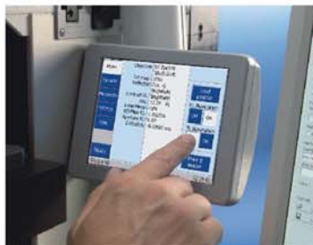
在 TFT 屏上设定照明
