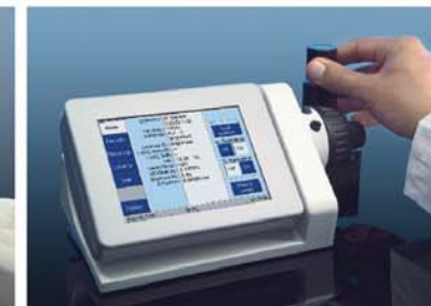
在工作站透过 TFT 显示器控制自动载物台。
