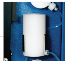
溶剂混合池可以在线混合溶剂
