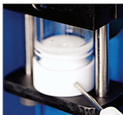
带有独立废液管路的封闭流路系统保证了样品的完整性
