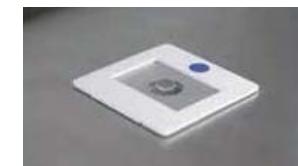
EDX使用方法 关闭样品架，将聚丙烯薄膜的表面朝向X射线照射侧（下侧）。
