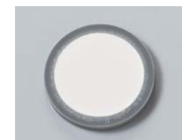
用压片机加压成形（压力成型法）
