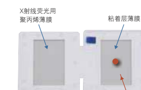
打开样品架后的情形（内侧） X射线荧光用聚丙烯薄膜 粘着层薄膜 粘附样品
