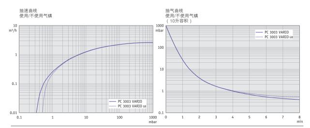
更多信息请查询 www.vacuubrand.com 抽气速度和抽气时间仅供参考。极限真空参数:请见"技术参数"
