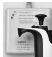
图 11 Rainin RFID 阅读器
