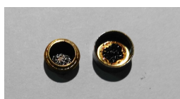
左图是测试样品到分解温度后坩埚内的样品
