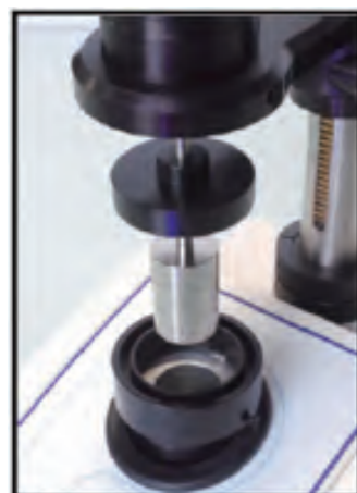
溶剂阱系统可以在样品使用液体密封方式时保证溶剂不会挥发或干燥
