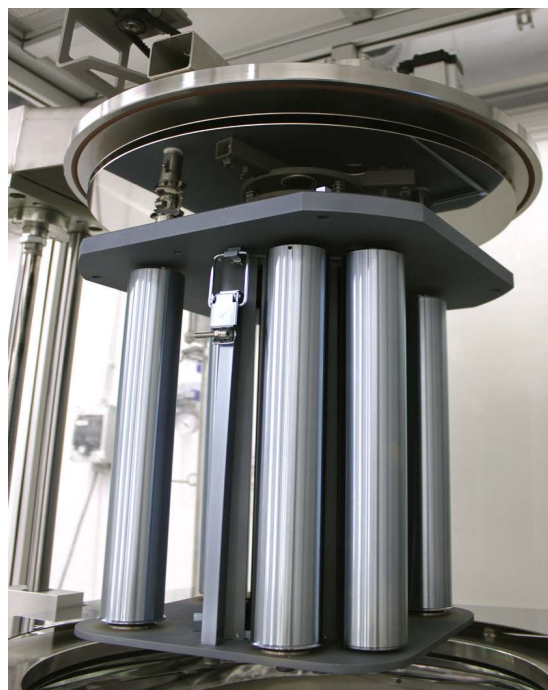
Picosun 生产型的卷对卷ALD设备可以实现大面积衬底连续加工。
