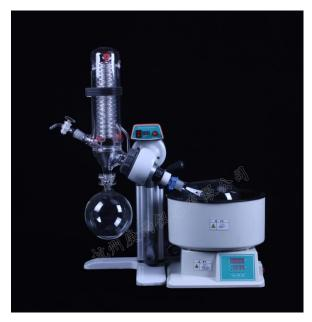
旋转蒸发器是医药、化工、生物制品等行业科研和生产过程中蒸发、浓缩、结晶、干燥、分离、溶媒 回收等过程必不可少的仪器设备。 旋转蒸发器是在真空负压条件下,利用恒温加热,薄膜蒸发的原理研制而成。旋转蒸发器用无级调速使玻璃旋转瓶恒速旋转,物料在瓶壁形成大面积均匀薄膜,再由 智能恒温水浴锅对旋转瓶均匀加热,在真空条件下高速蒸发,溶媒蒸气经高效玻璃冷凝器冷却,回收于收集瓶。旋转蒸发器是在真空条件下工作,且与物料接触部分全部采用耐高温高硼硅玻璃和聚四氟 乙稀材料,特别适用于对高温容易分解变性的生物制品的浓缩提纯。本厂旋转蒸发器集国内外同类产品之精华,集厂成功实践经验,已形成 2L、5L、10L、20L、50L、100L 系列,产品设计遵循高效、实用、经济原则,一切为用户着想。
