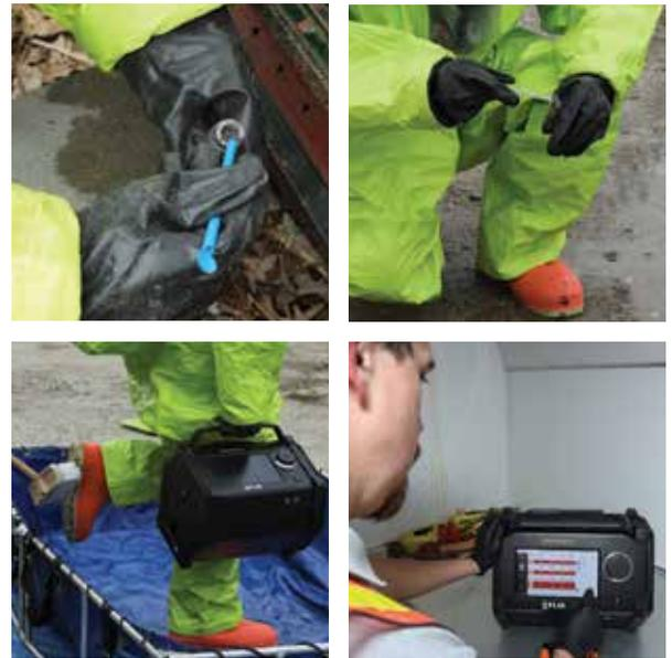
使用FLIR Griffin G510进行现场样品采集、分解和化学鉴定
