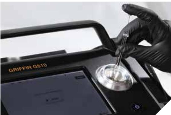
FLIR Griffin G510具有集成的分流/不分流液体注射器和加热样品探针，用于现场分析未知情况
