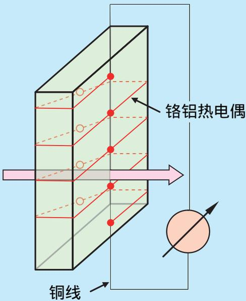
热流计的传感器使用热传导率小的薄板材质，热电偶也不仅仅用一对，为了使灵敏度提高，采用多个热电偶连接的方式。
