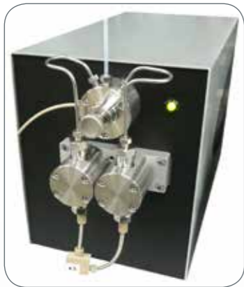
外置式进样泵流速可达50 mL/min, 压力可达300 bar, 满足大体积进样需求
