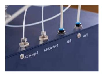
氦作为载气,用于运送从燃烧反应器产生的气体通过各种过滤器到热导检测器。整个系统是由一个自动取样器(AS)、一个燃烧反应器(CR)、一个还原反应器(RR),三个除水装置(F1、F2和F3)、二氧化碳吸附器(F4)和热导检测器(TCD)组成。
