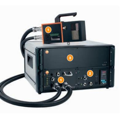
使用德图的旋转盘稀释器testo MD19-3E ①,可以进行热稀释。旋转盘稀释器与空气蒸发管-testo ASET15-1 ②,以及数据采集装置 testo CU-2 ③ 相结合,组成了一整套热稀释系统,即testo ViPR 挥发颗粒取样器testo ViPR。
