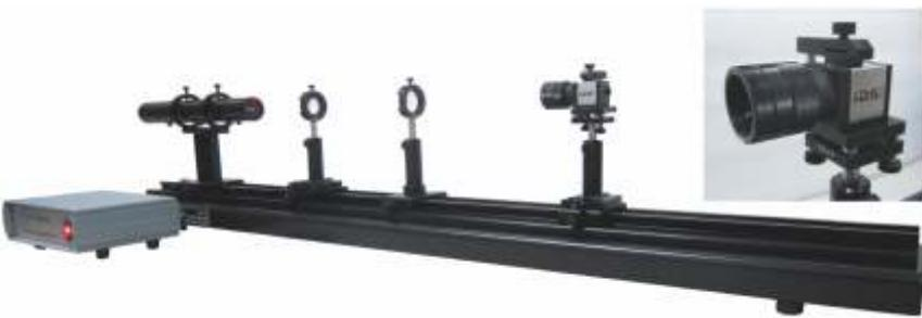
统。测量了He-Ne激光器的光束光强分布，计算出高斯光束参数，并用双曲线拟合法测量出质量因子。整套系统光路结构简单，使用面阵CCD作为探测系统，激光束经衰减后直接照射在CCD上，这样CCD采集到的图像大小和形状与入射的激光光束截面大小和形状完全相同(用像素的大小表示)。并对图像进行必要的处理，主要是进行图像平滑处理和进行图像灰度校准。随后选取经过校准的数字图像信号进行分析和计算，求出激光束的相关参数。本实验涉及光、机、电等方面知识，很适合于光学专业实验教学，也可用于普通要求下的光斑测量。
