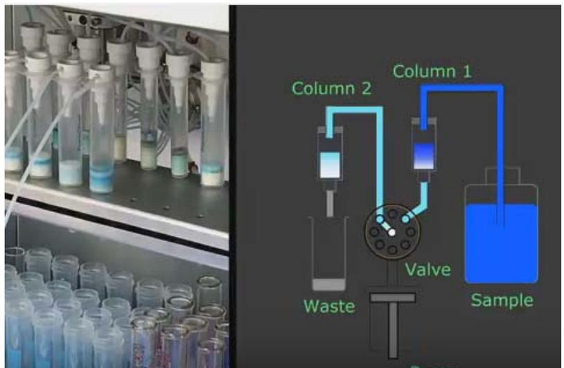
利用注射泵的吸力和 SPE-01 特有的样品管接口，可以实现流速稳定的负压上样。使用真空泵+密封玻璃缸的手动固相萃取，一个最大的缺点就是流速会随着萃取柱堵塞程度的变化而波动，从而影响分析结果的重复性。SPE-01 的负压上样，通过控制注射泵的抽吸速度，可以保持稳定的上样流速。更重要的是这种负压上样可以
