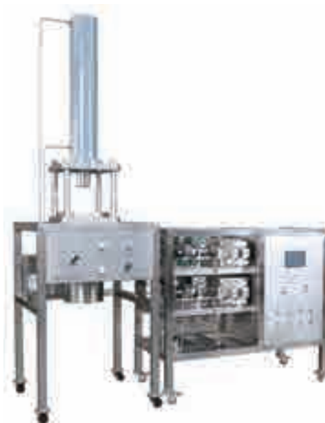
DAC300 制备色谱柱及控制系统
