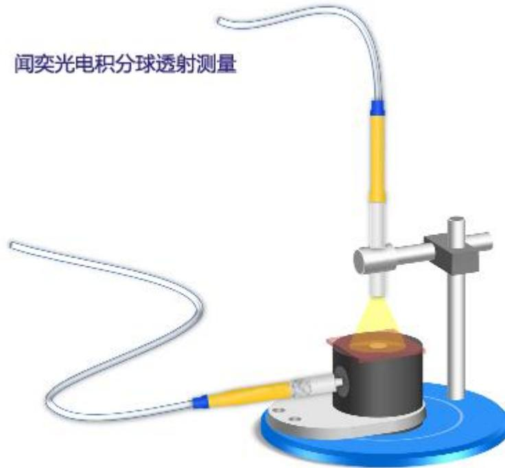
积分球透射光谱测量支架，适用于具有毛糙表面的样品反射光谱测试，如聚光玻璃、毛玻璃等
