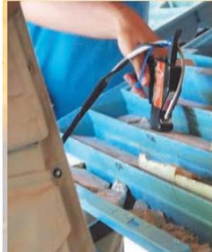
对岩芯进行快速和准确记录。采集的光谱可用 EZ-ID 进行实时的矿物鉴别，或者存储后用第三方软件进行化学计量学分析。
