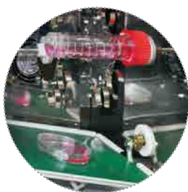
WHI-202R 内部 包含管支架和摇摆平板
