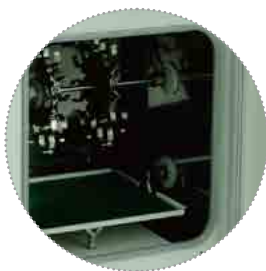
WHI-202R 内部 包含管支架和摇摆平板
