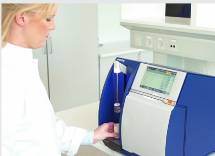
将冷却的牛奶放置在移液管下，按开始键。
