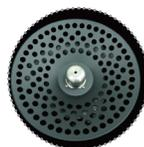
真空口是在转子的中心, 确保样品污染率降到最低
