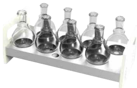
专用收集架， 接收瓶直接旋蒸
