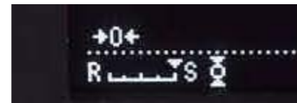
向左移动提高灵敏度，向右移动提高稳定性。5种设置等级可供选择。
