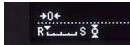
向左移动提高灵敏度，向右移动提高稳定性。5种设置等级可供选择。
