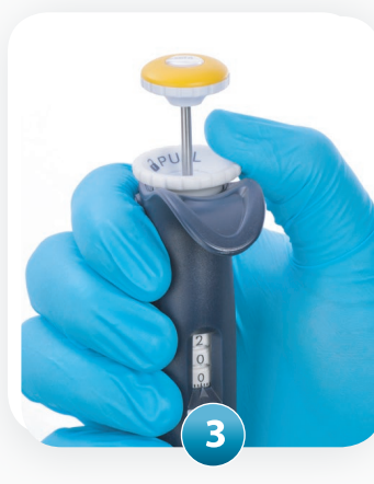
向下按拇指旋轮锁定并开始移液
