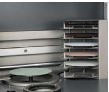
第一步：MD磨盘的中部将需要替换的MD耗材举起
