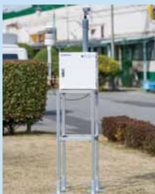
事例2) 架台 根据所设置的场所而制作。
