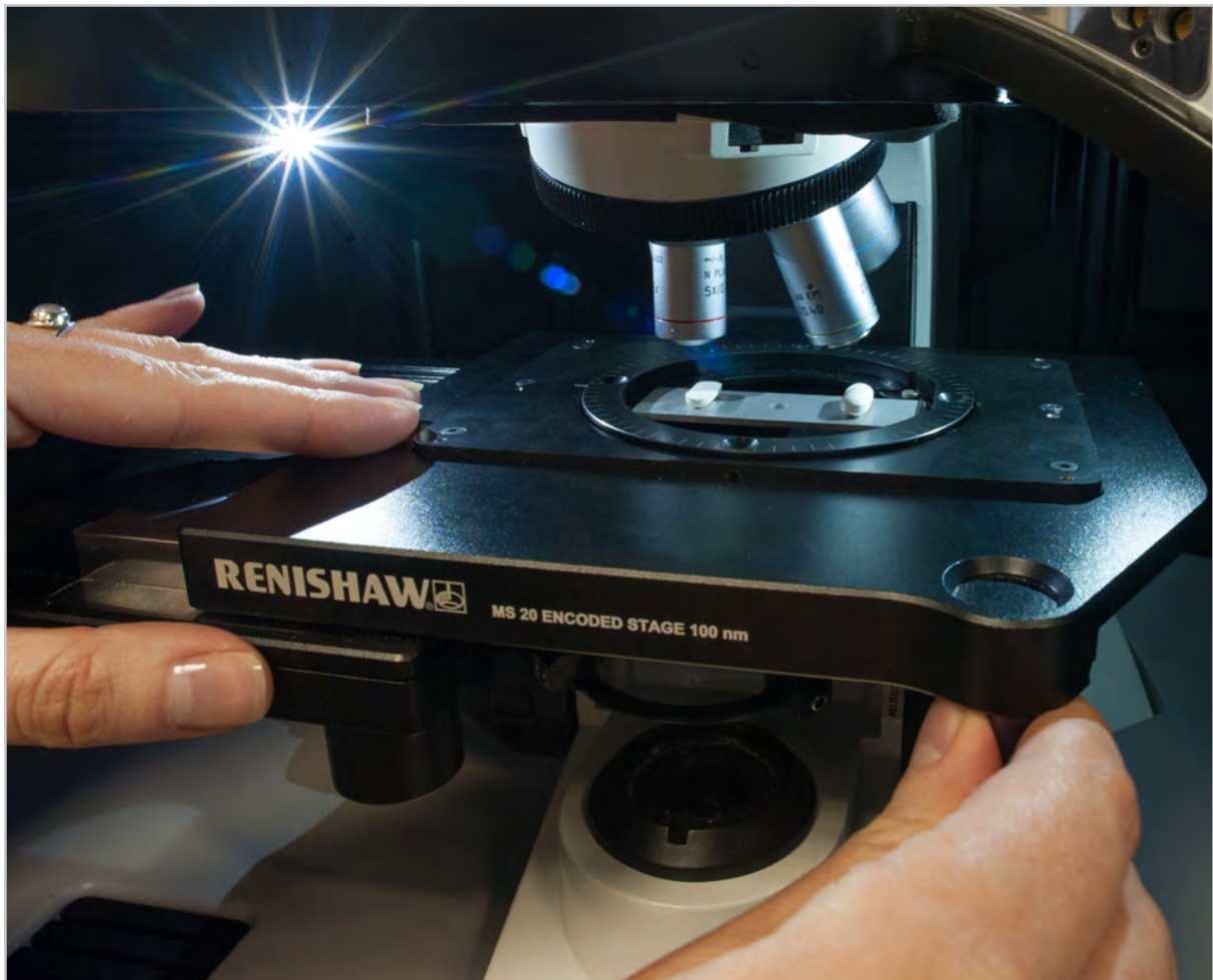
雷尼绍获得专利的马达驱动样品台使用编码器来跟踪其位置变化，即使在您手动移动样品台时也是如此。
