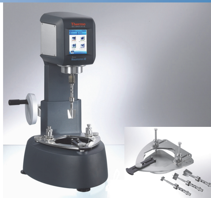
图1: Thermo Scientific HAAKE Viscotester iQ流变仪，通用夹持器及桨叶转子FL26-2叶片（左）；具有三个叶片转子的万向支架；4叶片转子FL16和FL22以及FL26-2叶片（右）
