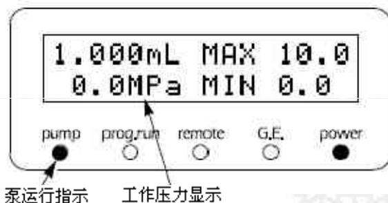
泵运行后，须注意观察显示面板上工作压力的显示值，确保压力上升并逐渐达到一个稳定值，一般压力波动的上下幅度不应大于 0.5MPa。
